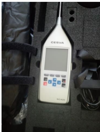
Слика бр. 18: Инструмент за акустична мјерења CESVA SC420
